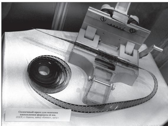
Секционный пресс для монтажа киноленты формата 16 мм, СССР, г. Ставка, завод «Панаш», 1973 г.
