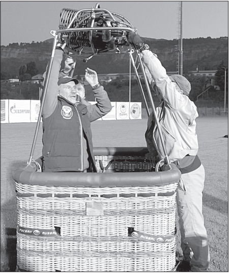
● Виталий Ненашев с помощниками устанавливает на гондолу газовые горелки.
