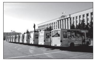
Автобусы произведены в Павловске, рассчитаны на 21 пассажира и оснащены всеми необходимыми для перевозки детей системами безопасности. В том числе двухточечными ремнями безопасности, экстренной связью с водителем для каждого пассажира, устройством, препятствующим открыванию дверей во время движения. Как было продемонстрировано, автобус даже не заводится, пока дверь в салон не закрыта.
