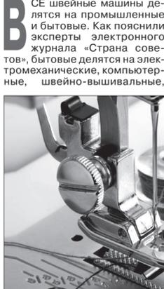
Максимальная длина стежка бывает до 5 мм, максимальная ширина зигзага - до 7 мм. Чем эти параметры больше, тем лучше: расширяет поле возможностей. Важен и тип челнока: он бывает вертикальный, со съёмным шпульным колпачком, а также горизонтальный - без него. Второй вариант, по мнению специалистов, современнее и надежнее - в нем меньше деталей, которые могут сломаться.
